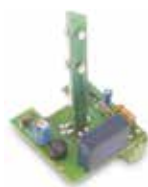
DSL UNI AU02750 Scheda Lampeggiante Universale Codice AU02750
