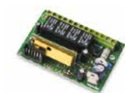
AU02810 Ricevente radio 433 MHz 4 canali
